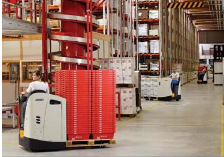
**Transporte optimizado, conductor sentado** – Las tareas críticas, con gran nivel de exigencia, precisan de una transpaleta que esté siempre a la altura y que constituya un puesto suficientemente cómodo para que el operario mantenga el ritmo durante todo el turno de trabajo. La RT de conductor sentado ofrece gran aceleración, **velocidades de desplazamiento de hasta 12,5 km/h**, asiento y reposapiés ajustables, y una posición más alta que mejora la visibilidad en todas las direcciones.
