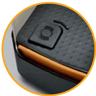
**La barra de seguridad perimetral patentada** desactiva la función de desplazamiento cuando el operario saca el pie de la plataforma.
