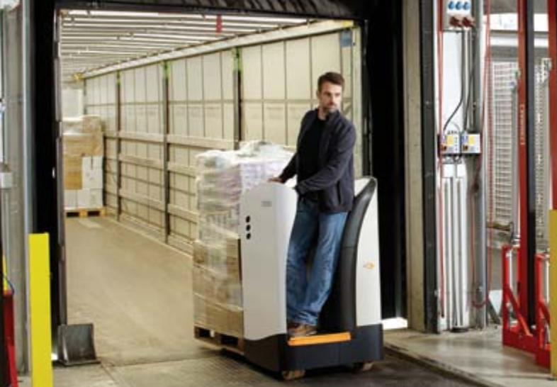
**Trabajo rápido en muelles** – Gracias a su excepcional maniobrabilidad, a sus mandos de control intuitivos, a la suspensión de la plataforma y a su anchura, de tan solo 780 mm, la RT con conductor de pie permite cargar y descargar rápidamente las mercancías de los camiones.
