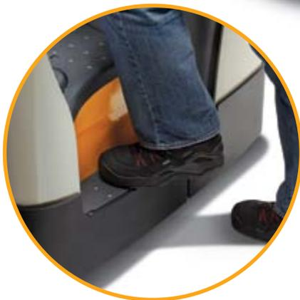
**El peldaño de baja altura** facilita la entrada y la salida. Además, reduce la fatiga del operario y mejora la seguridad.
