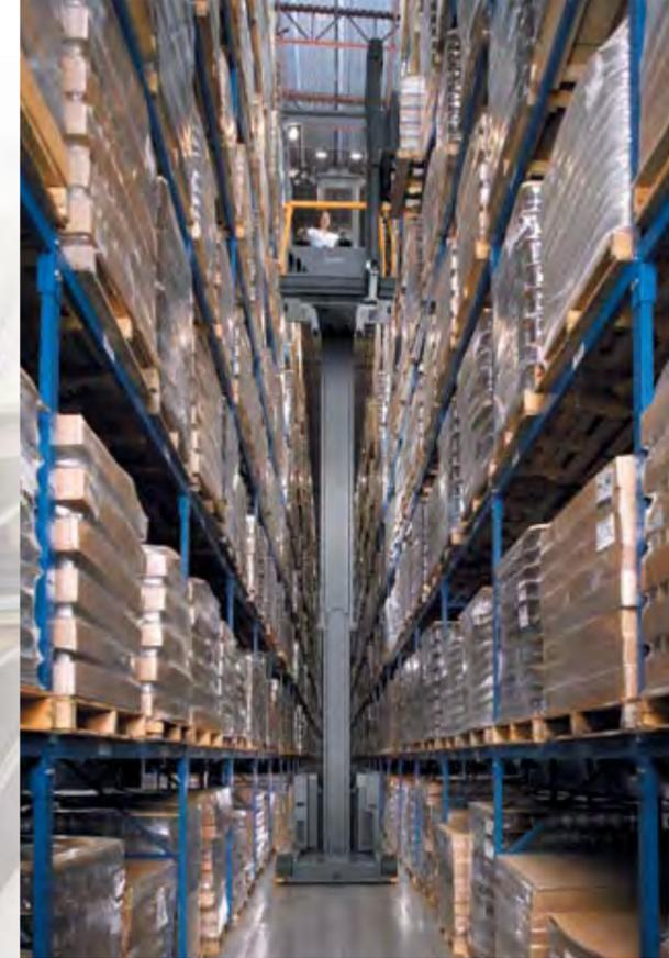
**MANIPULACIÓN DE PALLET COMPLETO:** La ubicación y retirada de cargas completas a gran altura es un trabajo exigente, que se ha simplificado. La extraordinaria estabilidad del mástil MonoLift y la gran precisión de los mandos de control confieren exactitud y sencillez a la manipulación de cargas pesadas.
