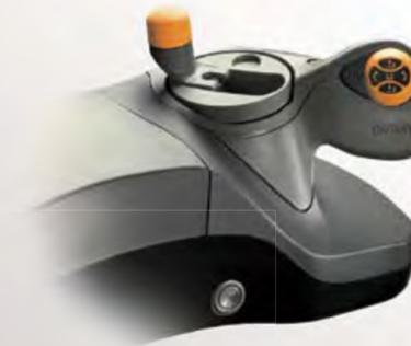
Los sensores de mano en ambos mandos de control garantizan una posición adecuada para que el operario trabaje con seguridad.
