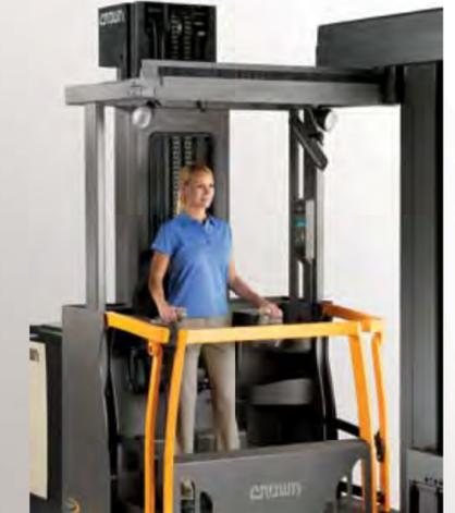
Las tareas que se realizan preferentemente de pie pueden llevarse a cabo con total eficacia; basta con plegar el asiento y ajustar los controles a la altura ideal del operario.
