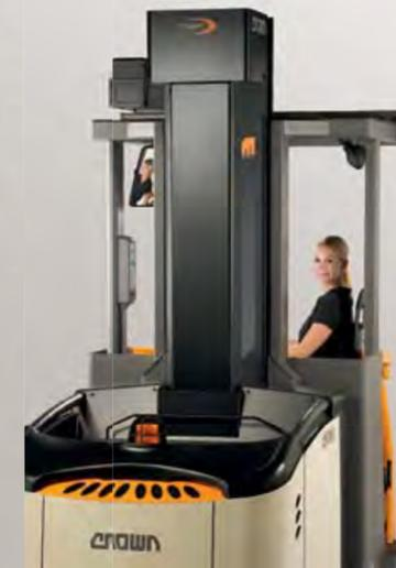
El diseño descendente de la cubierta en la unidad de tracción y la flexibilidad en las posiciones de asiento ofrecen al operario una visibilidad totalmente despejada, mejorando la maniobrabilidad y las operaciones dentro y fuera del pasillo.
